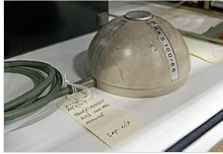
The ball-based Telefunken Rollkugelsteuerung RKS 100-86 from 1968
